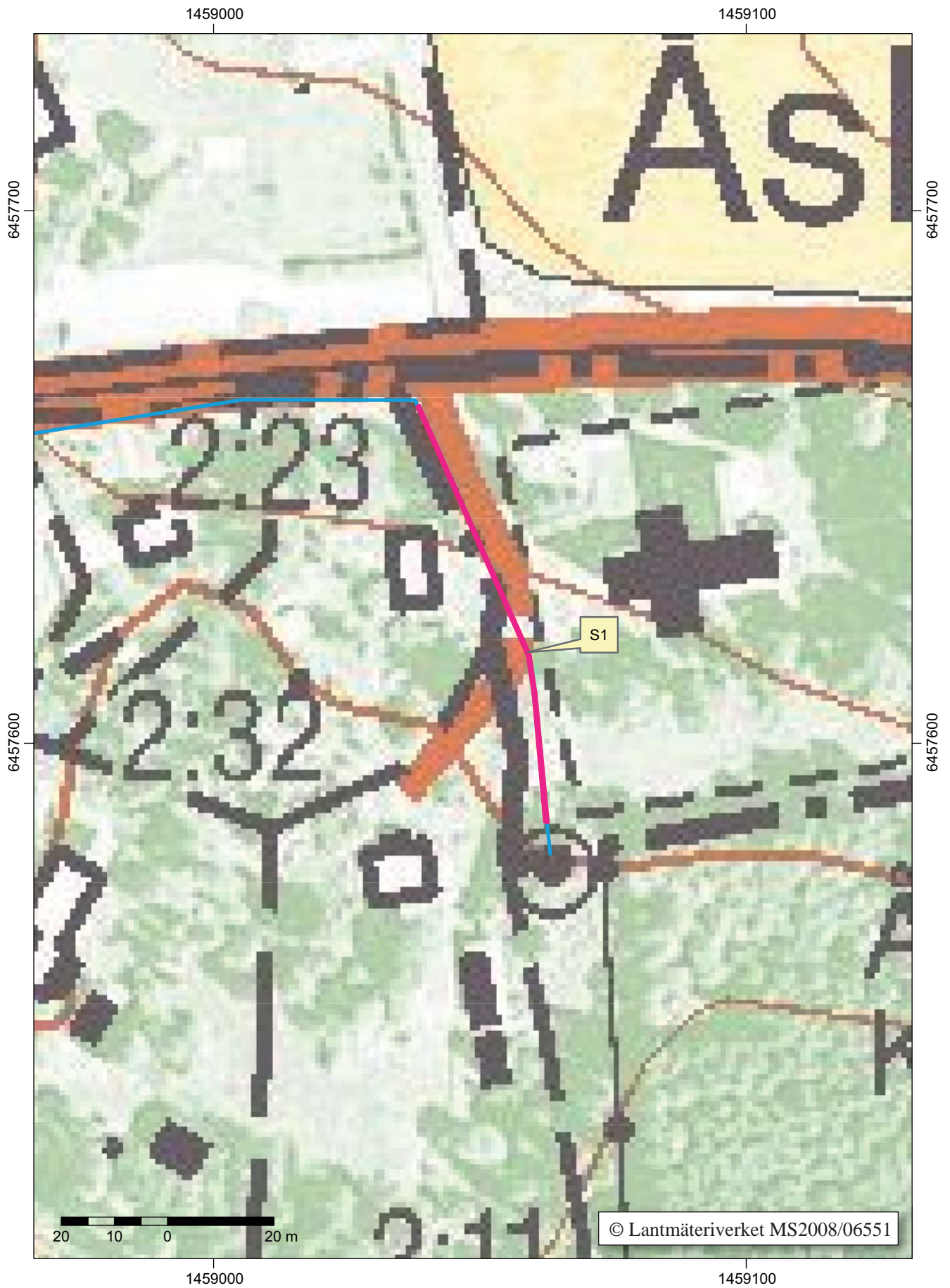
Figur 5. Utdrag av fastighetskartan med schakt 1 markerat med lila. Den nya ledningsträckningen är markerad som blå linje. Skala 1:1 000.
